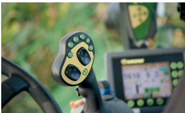
Le conducteur peut durant le travail activer l'automatisme de guidage par le biais du levier multifonction KRONE. Un appui sur un bouton suffit et la BiG X suit le chemin assigné. Grâce au guidage automatique, le conducteur est moins sollicité, le rendement horaire est renforcé, même sur les semis larges et le débit est donc supérieur.
