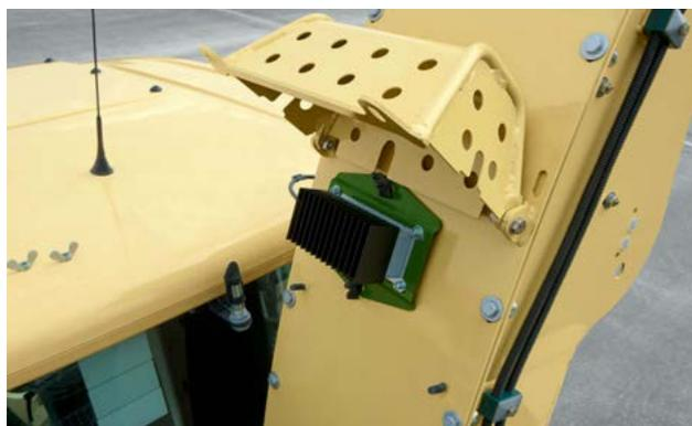
La mesure de la teneur en humidité se fait sur le coude éjecteur de la BiG X. Le flux continu de la récolte sur ce point est à la base d'une saisie de données parfaite. Le capteur est facile à monter et il est protégé par un cache.
