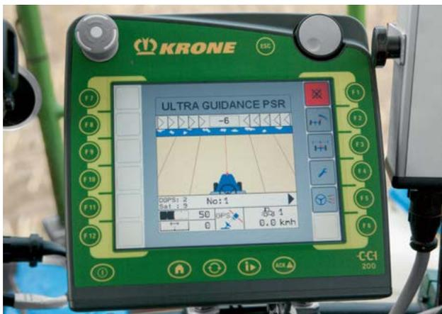
La BiG X est prééquipée en option pour les systèmes de guidage ISOBUS de différents constructeurs. L'avantage évident est l'utilisation simple des systèmes de guidage déjà existants selon le principe «Plug & Play». Un tel système est intégré en quelques minutes et la BiG X est immédiatement disponible avec un système de guidage ISOBUS de qualité supérieure..
